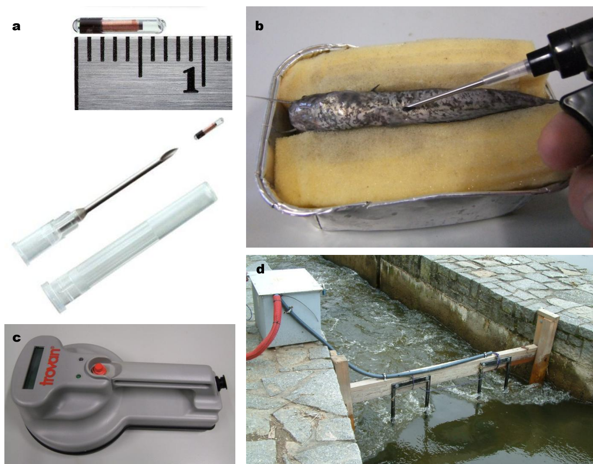
Obr. 11.2 Systém pasivních integrátorů – značka v injekční jehle (a), značení ryby (b), ruční čtečka (c) a detekční zařízení – anténa ve vodácké propusti na řece Sázavě (d).
