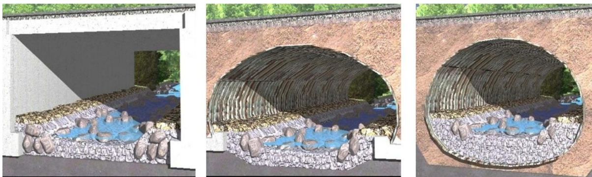
Obr. 7.15 Modely mostu a propustků s balvanitou úpravou dna
